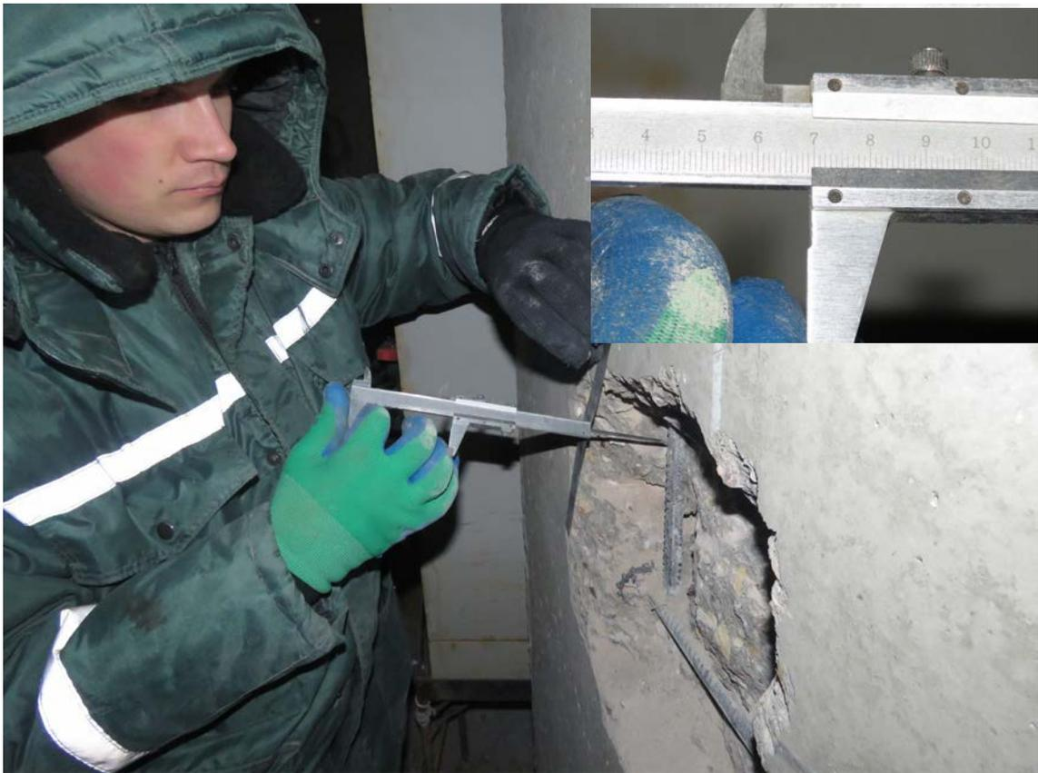
**Рис. 3.2.9. Замер защитного слоя бетона в монолитном пилоне подвального этажа в осях 31/2/К/2-Л/2**
