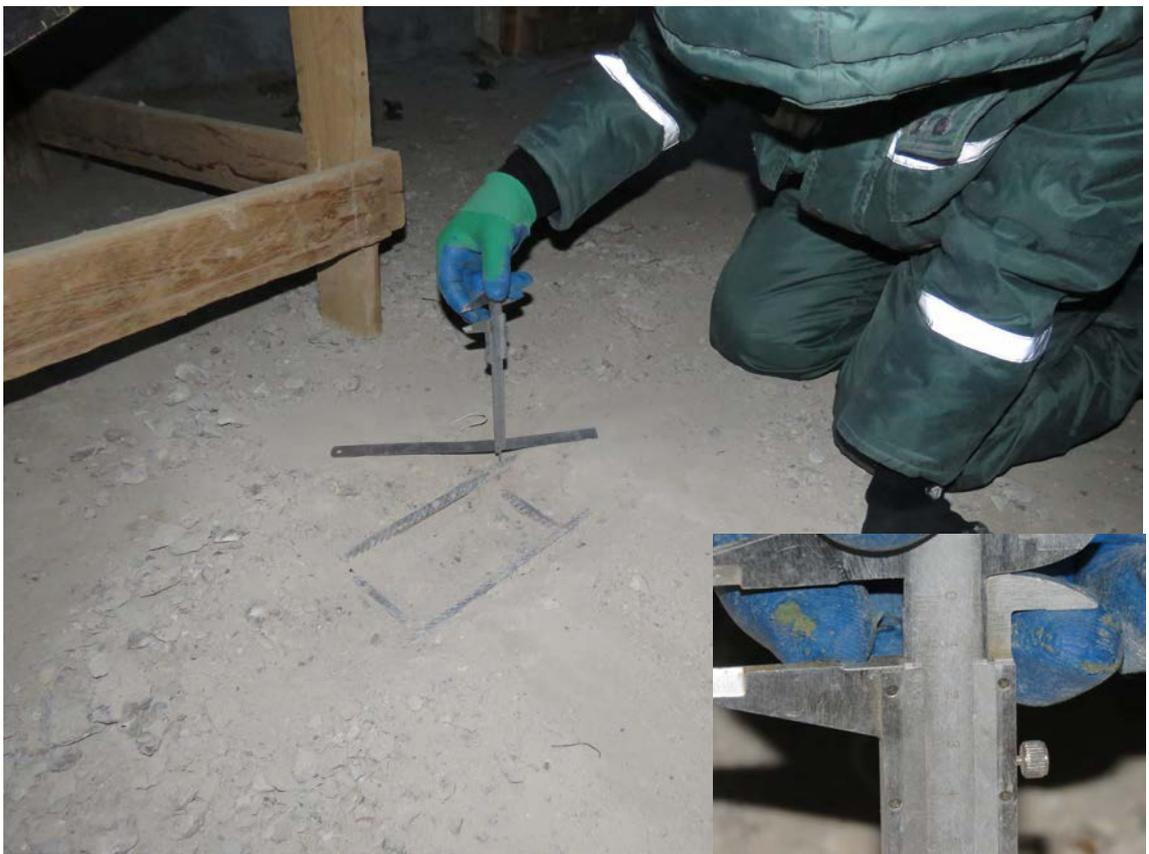
**Рис. 3.1.14. Замер защитного слоя бетона фундаментной плиты между осями 23/1-26/1 и А/1-Б/1**
