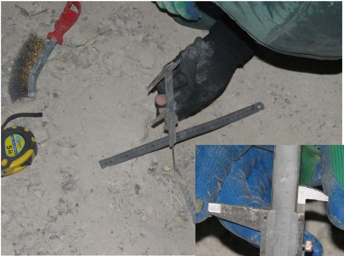
**Рис. 3.1.13. Замер защитного слоя бетона фундаментной плиты между осями 28/2-29/2 и Г/2-Е/2**
