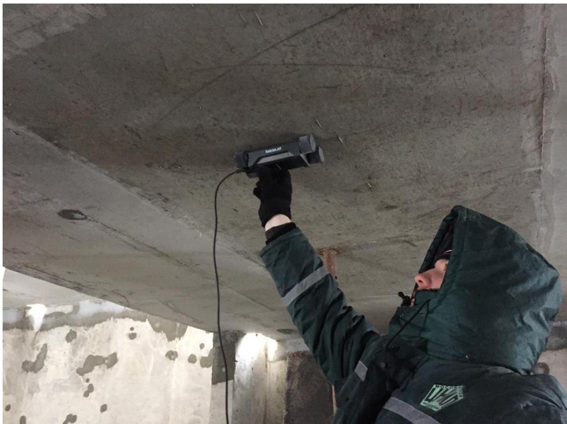
**Рис. 4.4.2. Замеры шага арматуры, определение величины защитного слоя бетона в монолитной железобетонной плите перекрытия подвала магнитным методом прибором «Profometer PM-6»**
