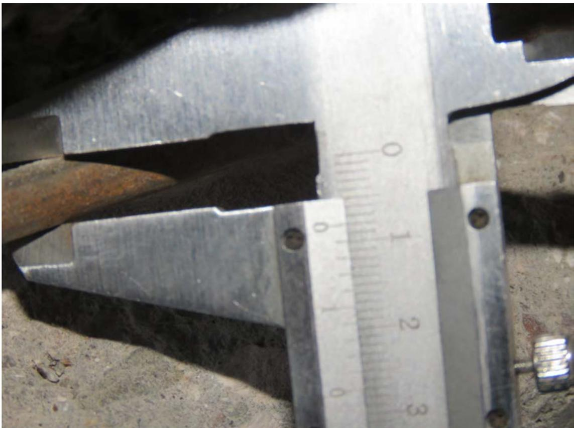
**Рис. 3.2.14. Замер диаметра арматурного стержня в монолитной стене второго этажа в осях 6/1/У/1.2-Х/1.2**
