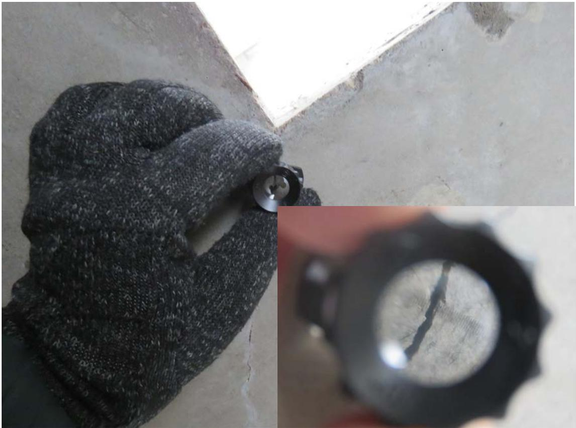
**Рис. 3.3.9. Замер ширины раскрытия трещины в монолитной плите перекрытия подвала**
