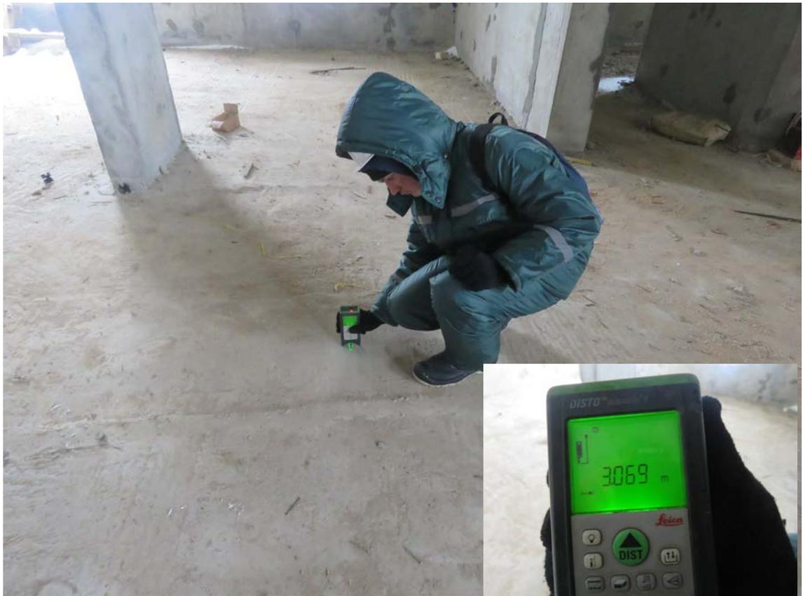
**Рис. 2.3. Замер высоты подвального этажа секции № 9 в чистоте**
