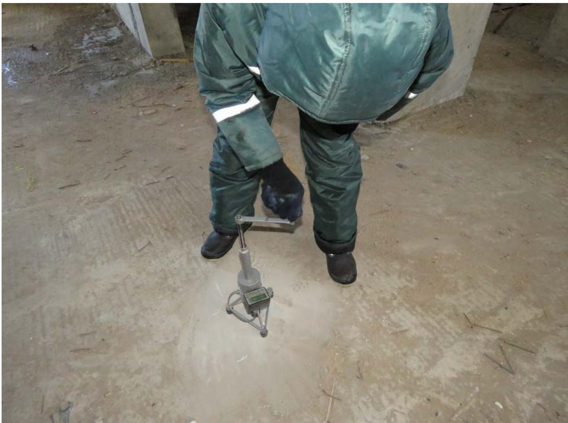
**Рис. 4.2.4. Испытание бетона монолитной железобетонной фундаментной плиты в осях В/1-Г/1/19/1-20/1 методом отрыва со скалыванием прибором «ПОС 50МГ-4»**
