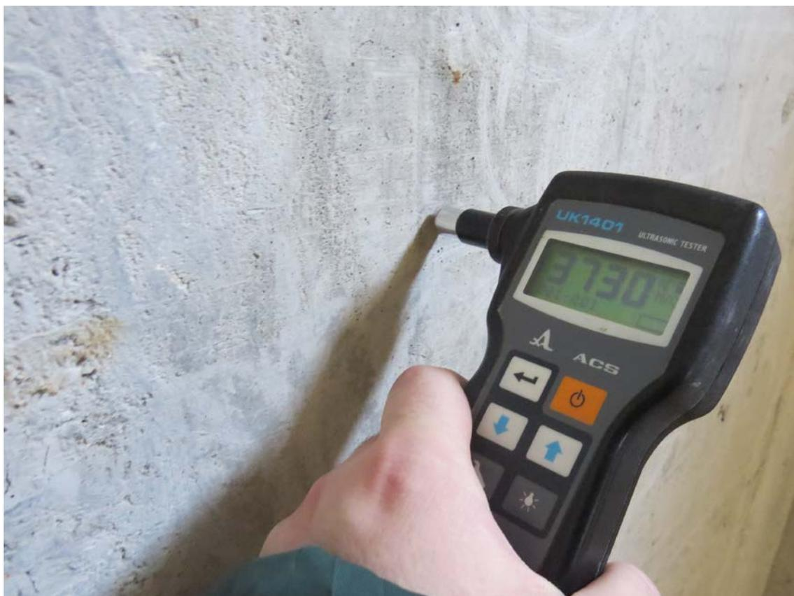
**Рис. 4.3.1. Определение скорости ультразвука в монолитной железобетонной стене подвала ультразвуковым методом прибором «UK 1401»**
