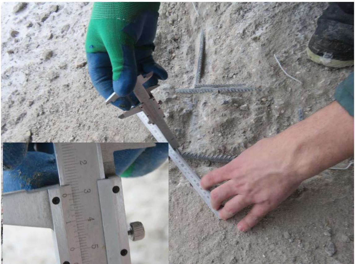
**Рис. 3.3.8. Замер защитного слоя бетона плиты перекрытия первого этажа в осях 9/1-10/1/Р/1.1**
