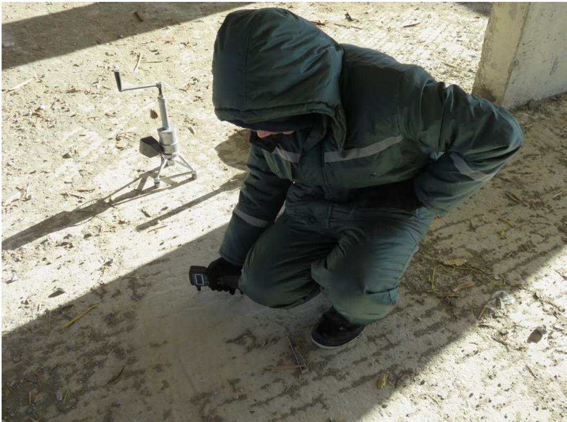
**Рис. 4.3.2. Определение скорости ультразвука в монолитной железобетонной плите перекрытия подвального этажа ультразвуковым методом прибором «УК 1401»**
