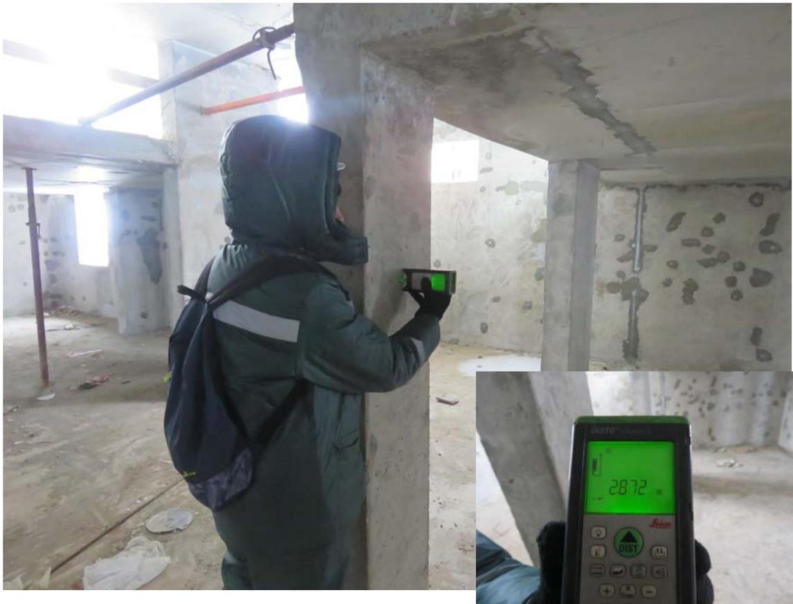
**Рис. 2.4. Замер расстояния между пилонами подвального этажа в чистоте**
