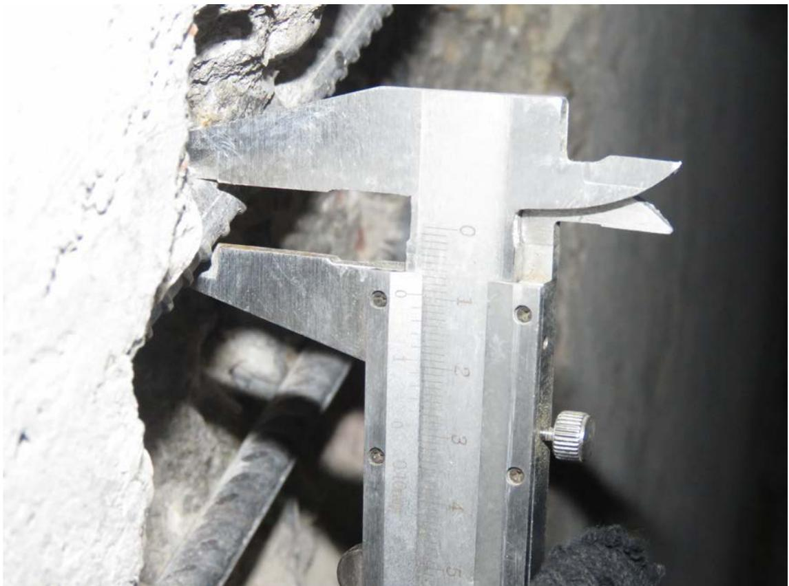
**Рис. 2.6. Замер диаметра арматурного стержня в монолитной стене**
