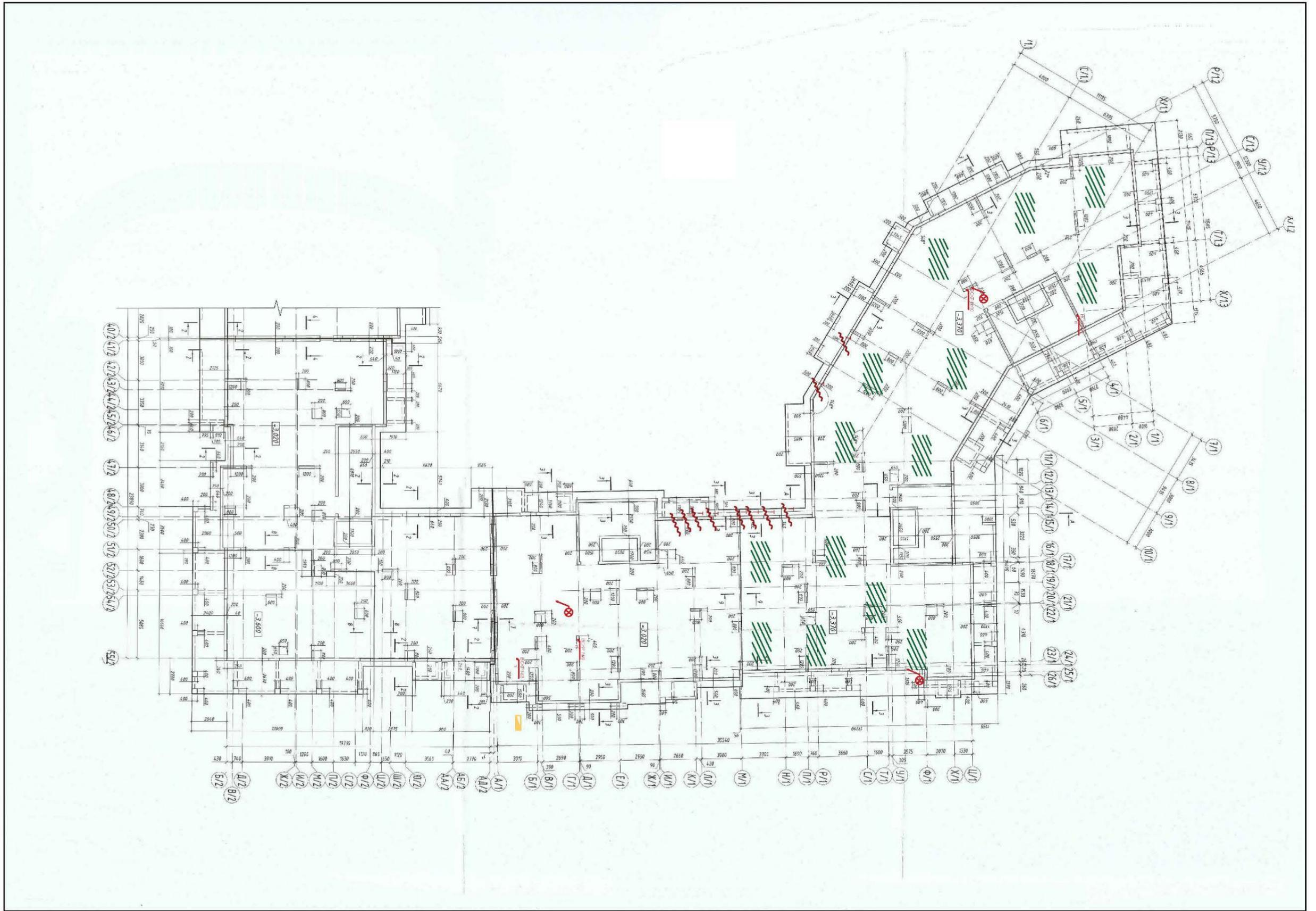
Рис.П5.6. Карта дефектов фундаментной плиты и вертикальных конструкций подвала (Секции 8,9,10,11)
