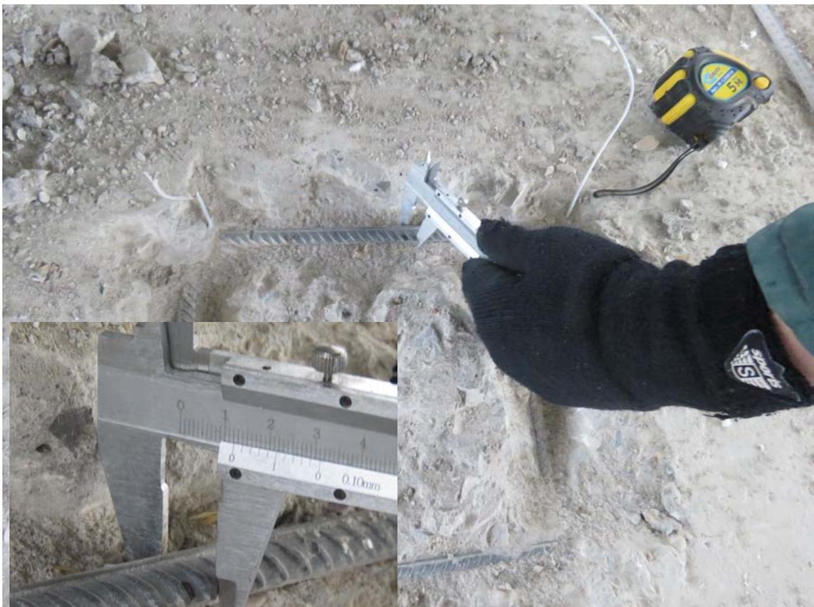
**Рис. 3.3.4. Замер диаметра арматурного стержня плиты перекрытия первого этажа в осях 9/1-10/1/С/1.1-Х/1.1**
