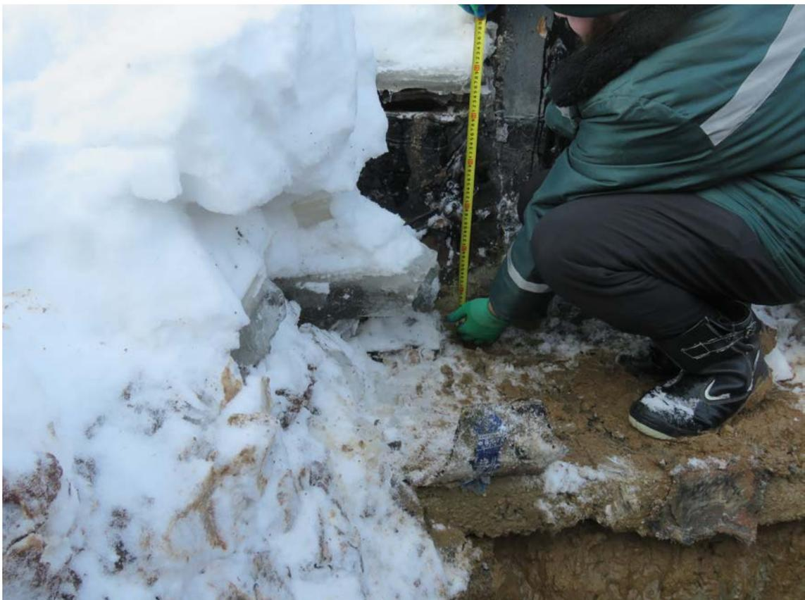
**Рис. 3.1.4. Замер толщины монолитной железобетонной фундаментной плиты в осях 22/2-24/2/А/2 (500 мм)**
