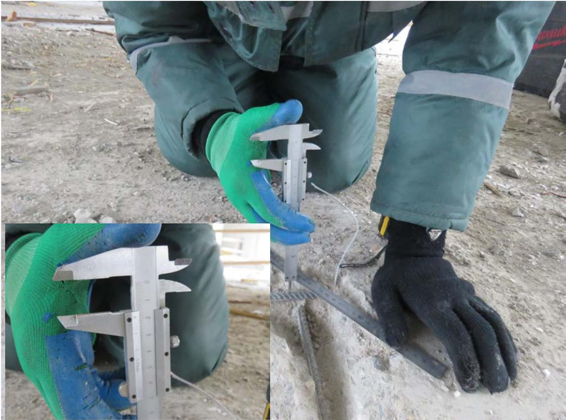
**Рис. 3.3.5. Замер защитного слоя бетона плиты перекрытия первого этажа в осях 9/1-10/1/С/1.1-Х/1.1**
