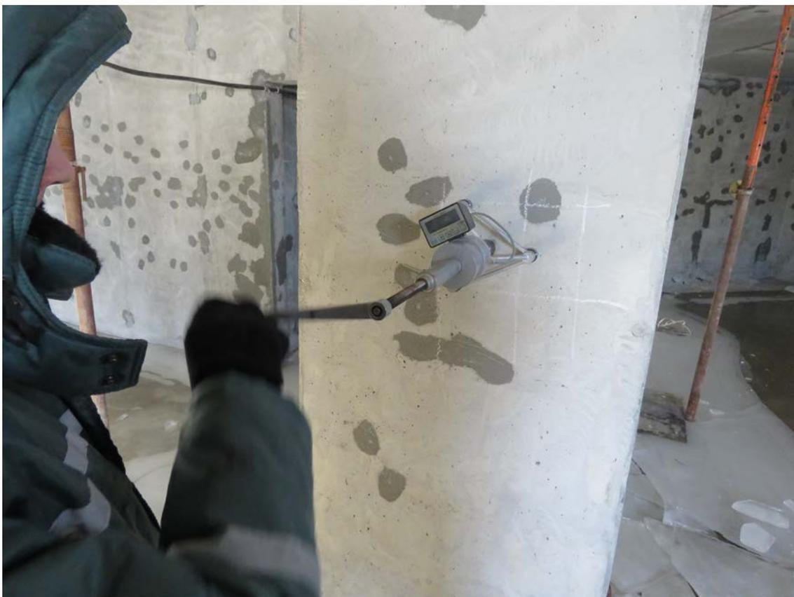
**Рис. 4.2.8. Испытание бетона монолитном железобетонном пилоне подвального этажа в осях 6/1/С/1.2 методом отрыва со скалыванием прибором «ПОС 50МГ-4»**
