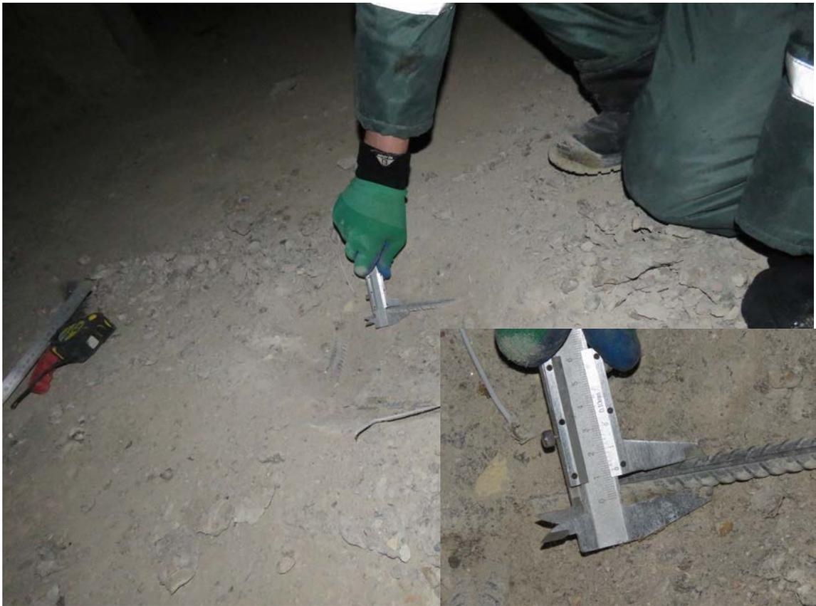
**Рис. 3.1.9. Замер диаметра арматурного стержня фундаментной плиты между осями 2/3-3/3 и А/3-Б/3**
