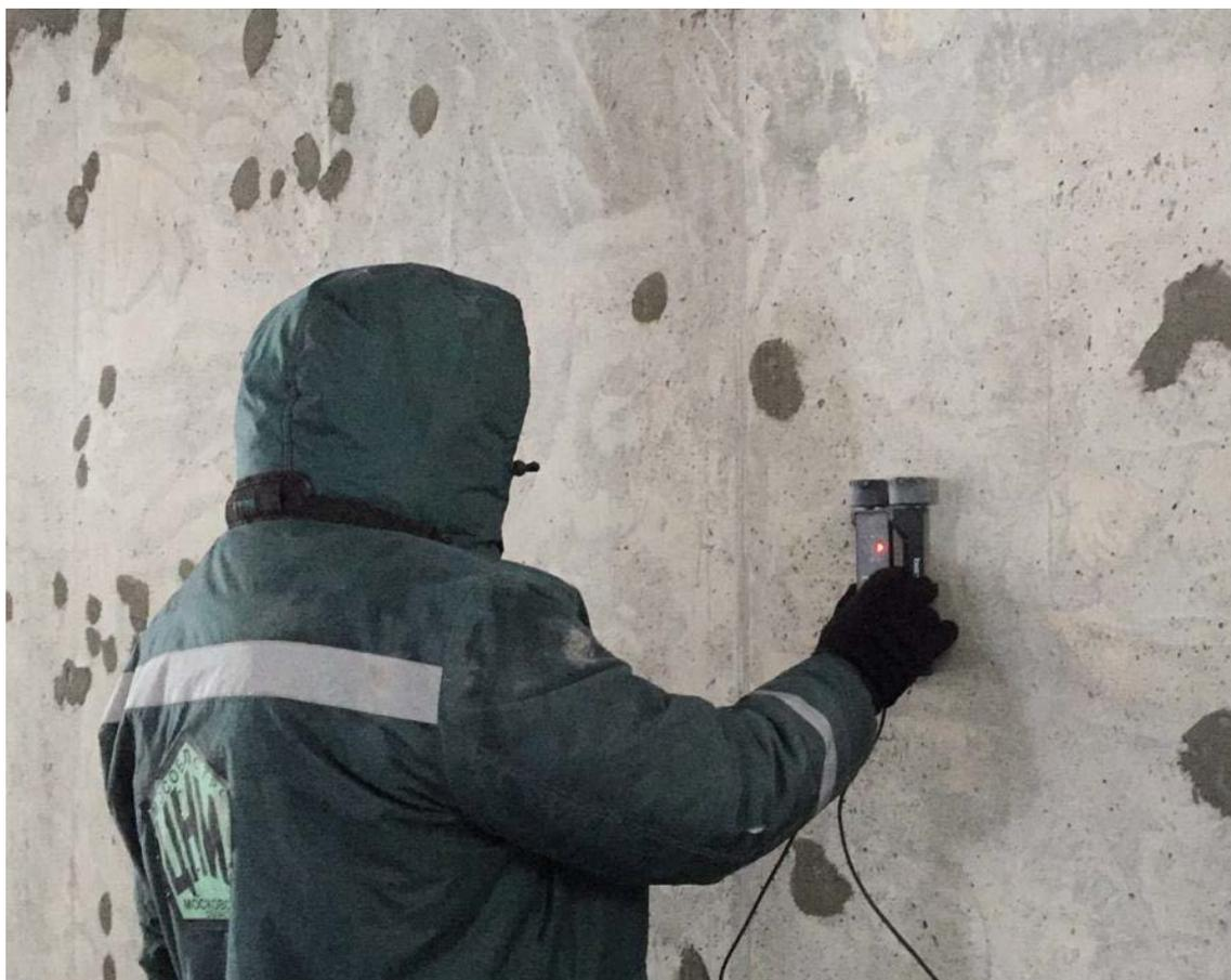
**Рис. 4.4.3. Замеры шага арматуры, определение величины защитного слоя бетона в монолитной стене первого этажа магнитным методом прибором «Profometer PM-6»**
