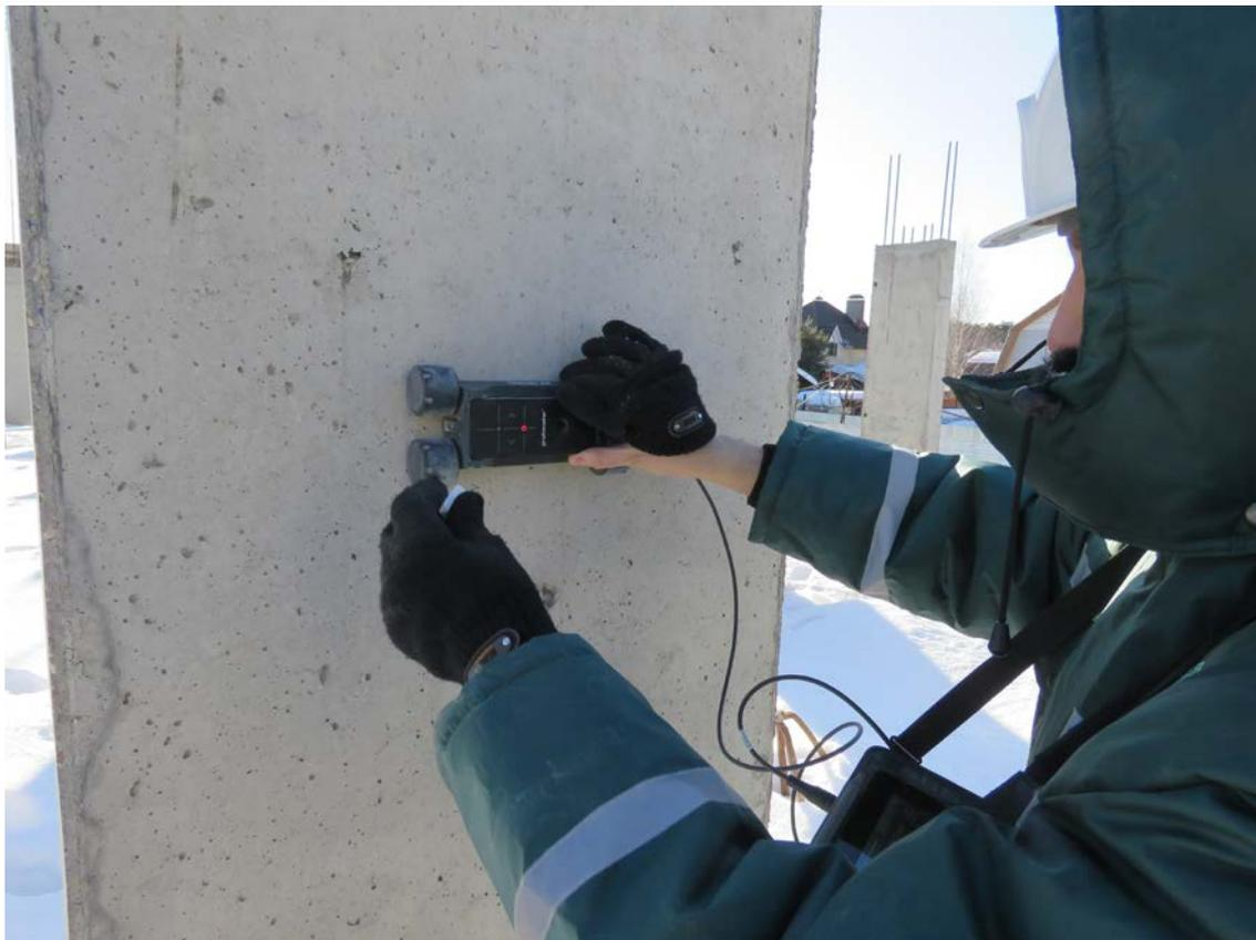
**Рис. 4.4.1. Замеры шага арматуры, определение величины защитного слоя бетона в монолитном пилоне первого этажа магнитным методом прибором «Profometer PM-6»**
