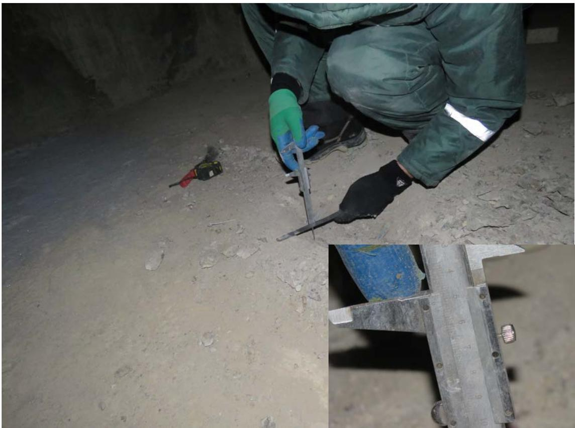
**Рис. 3.1.12. Замер защитного слоя бетона фундаментной плиты между осями 2/3-3/3 и А/3-Б/3**
