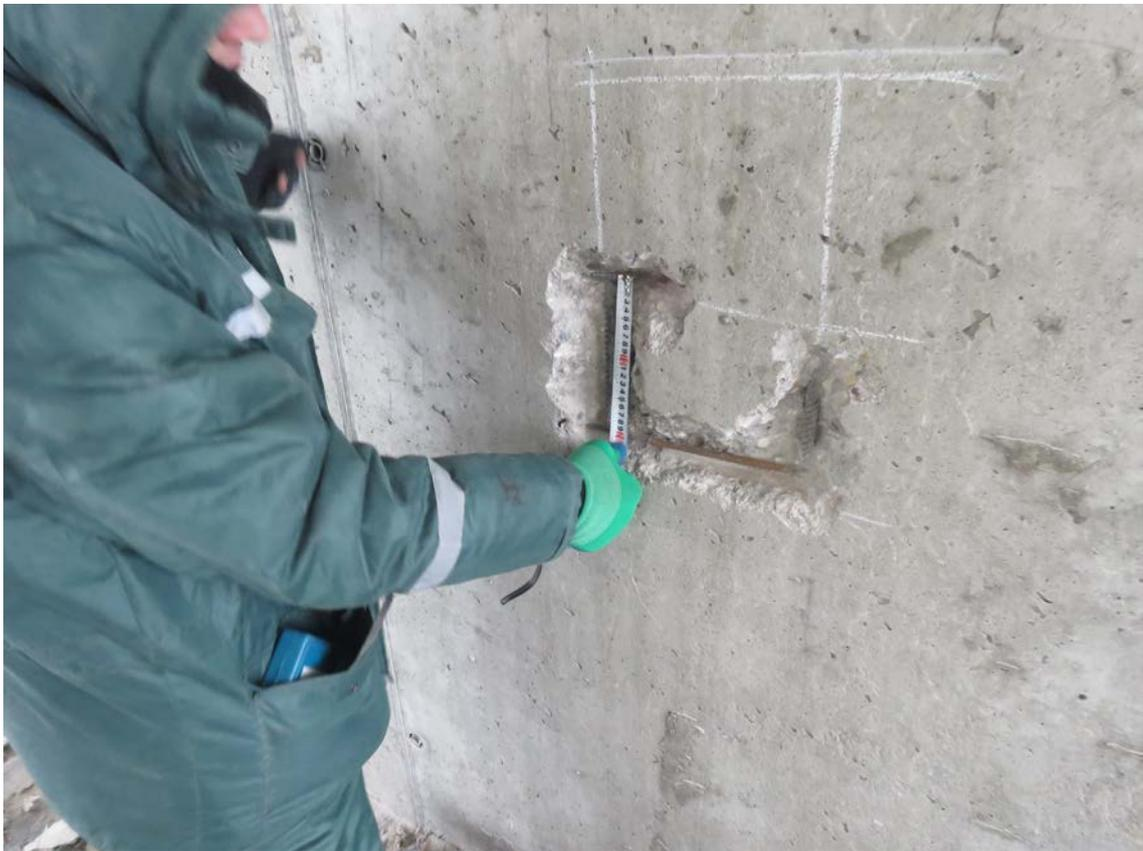
**Рис. 3.2.11. Замер шага арматурных стержней в монолитной стене второго этажа в осях 6/1/У/1.2-Х/1.2**
