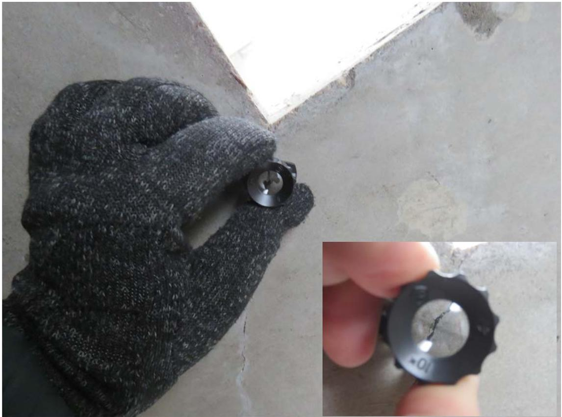
**Рис. 2.5. Замер ширины раскрытия трещины в монолитной железобетонной плите перекрытия подвального этажа**
