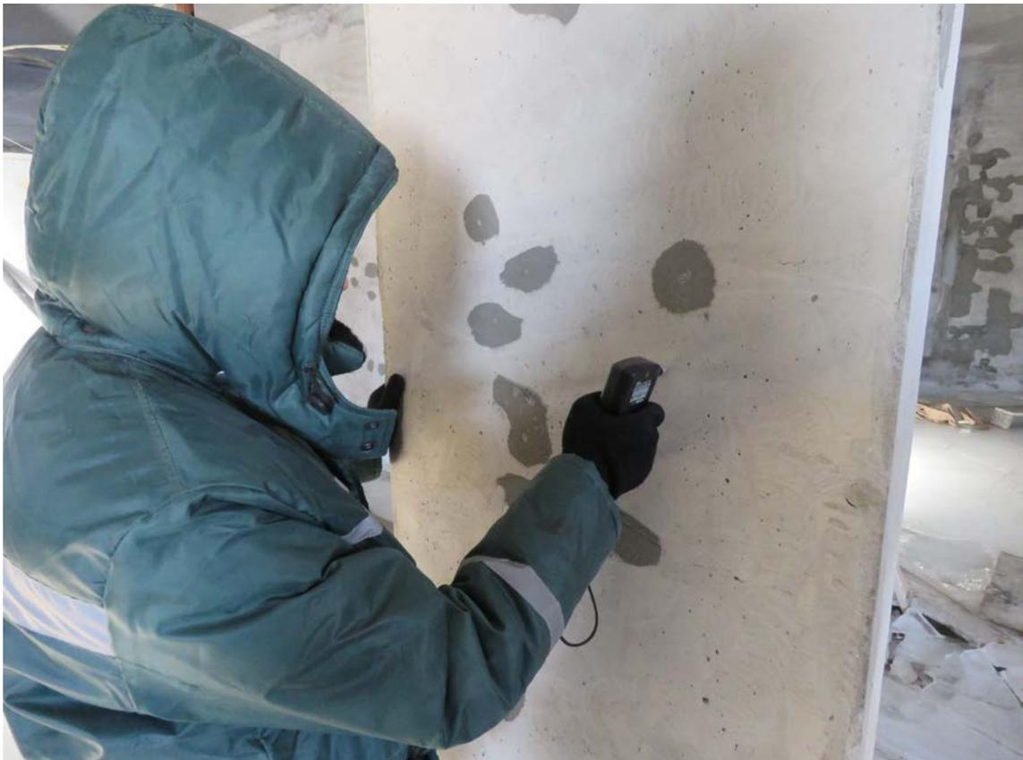
**Рис. 4.3.3. Определение скорости ультразвука в монолитном железобетонном пилоне ультразвуковым методом прибором «УК 1401»**
