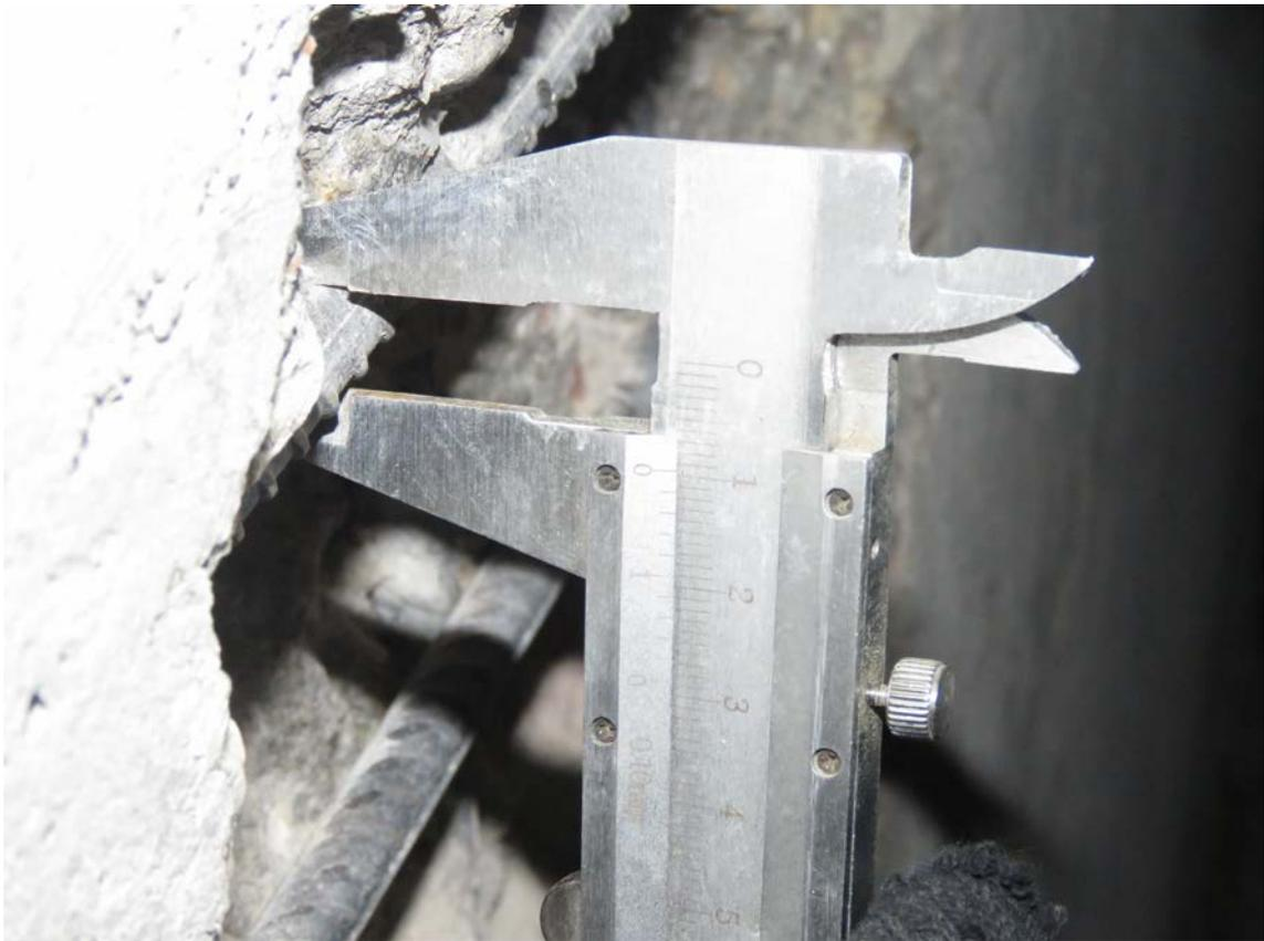
**Рис. 3.2.13. Замер диаметра арматурного стержня в монолитной стене подвального этажа в осях 4/1/У/1.2-Х/1.2**
