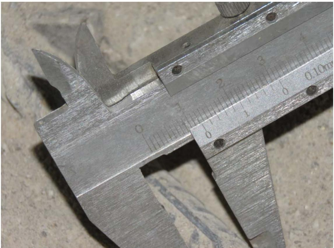
**Рис. 3.1.10. Замер диаметра арматурного стержня фундаментной плиты между осями 28/2-29/2 и Г/2-Е/2**
